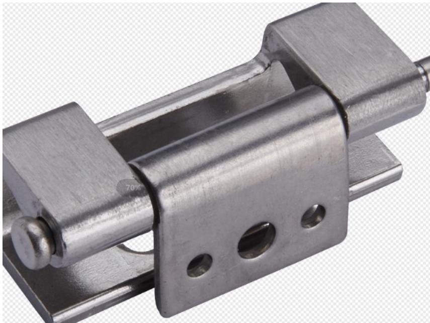
sus304铰链可通过冷加工获得高硬度和强度。在退火状态下，304型不锈钢铰链非常易延展，可以通过辊压成型，深冲，弯曲和其他常见制造工艺轻松进行冷加工。304不锈钢带通常因其高延展性，出色的拉伸，成形和纺丝性能而具有这些特征。合金加工迅速硬化，但是有时必须进行过热退火以恢复理想的延展性和降低硬度。已知304级不锈钢比302型具有更好的耐腐蚀性。就磁性而言，304不锈钢基本上是非磁性的，并且只在冷加工时才变成微磁性。304合金含有9至11%的镍，因此对中等侵蚀性有机酸具有抵抗力。304型不锈钢带材在氧化环境中也具有抗腐蚀性，这是304合金所含18至19%铬的结果。该合金甚至在低温下也具有出色的韧性。另一方面，就抗氧化性而言，该不锈钢合金可暴露于约1650°F的温度下，且可连续观察到明显的水垢。像大多数其他奥氏体钢种一样，可以使用常见的融合和电阻方法轻松焊接304型。天津304不锈钢铰链什么牌子好不锈钢铰链的寿命非常久，一个不锈钢铰链可以用好几年。
